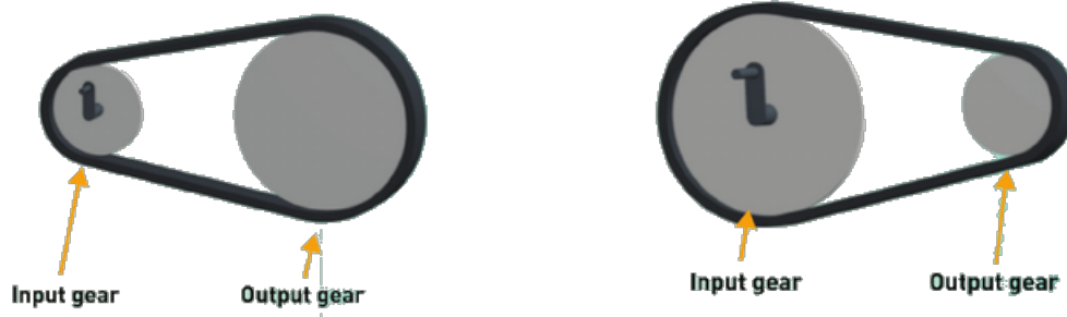
Εικόνα 5: Σύστημα γραναζιών. Το σύστημα αριστερά διπλασιάζει την ροπή T στην έξοδο, ενώ το σύστημα δεξιά αυξάνει την γωνιακή ταχύτητα, αλλά μειώνει τη ροπή T στην έξοδο στο μισό.
